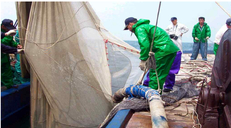
<사진-8> 파워블록으로 양망한 자루그물의 멸치를 피시펄프로 가공선에 이송하는 과정
