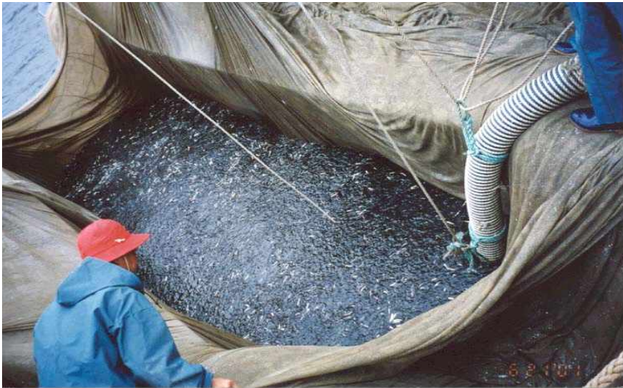
<사진-6> 자루그물의 멸치를 피시펌프로 가공선에 이송하는 과정
