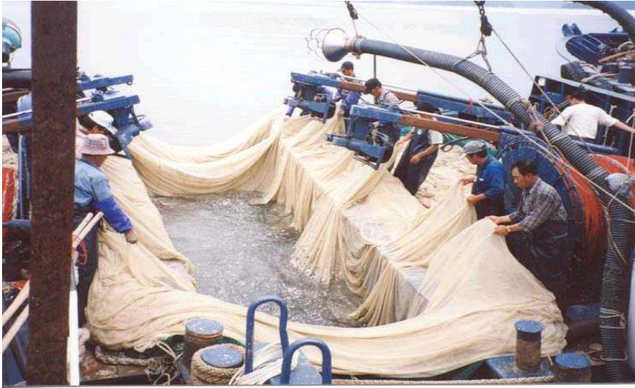
<사진-5> 권현망의 자루그물 양망하는 과정
