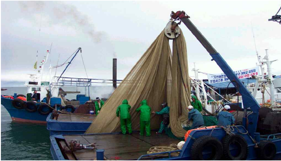
<사진-7> 권현망 자루그물을 파워블록으로 양망하는 과정
